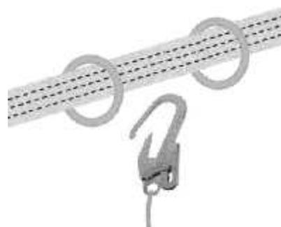
Por isso, a qualquer momento, apenas uma pessoa e/ou utilizador deve ser ancorada/ligada a cada um dos anéis em O.
