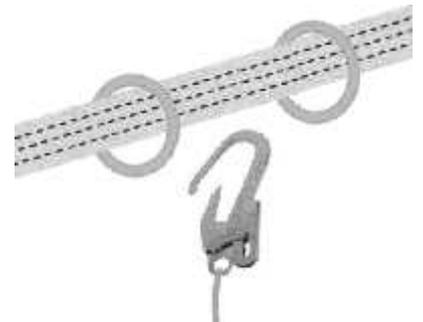
Тобто, в будь-який момент часу лише одна людина, і / або користувач повинен бути закріплений / прикріплені до кожного з О-подібних кілець.
